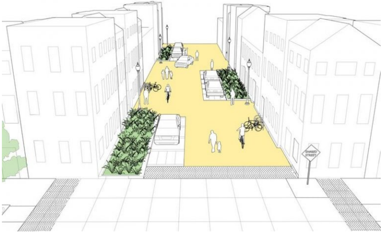
Figura 2.10 Esempio di strada a priorità pedonale
