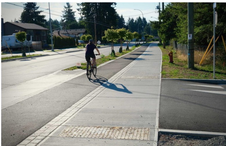
Figura 2.8 Esempio corretto di marciapiede continuo
